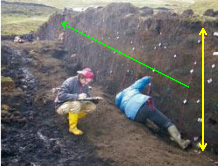
Déplacement vertical d'une Faille récente d'ordre kilométrique affectant le sol.
